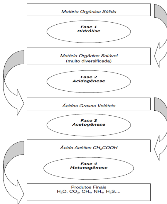
Figura 1: Fluxograma do processo de decomposição anaeróbia
