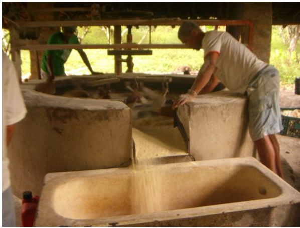
Figura 5. Homens no forno de torrefação motorizado de segunda geração (2012). Fonte: Projeto UFBA/FAPESB.
