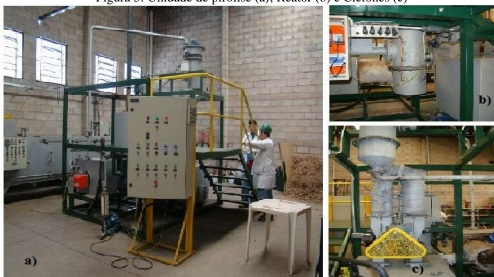
Figura 5: Unidade de pirólise (a); Reator (b) e Ciclonos (c)
