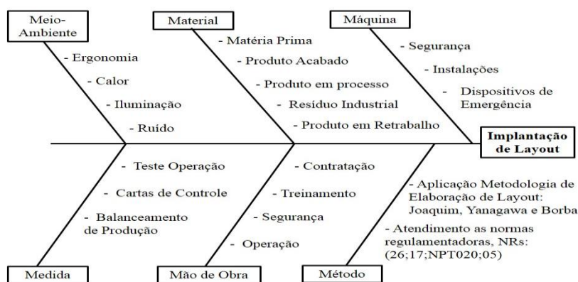
Figura 7 - Diagrama Causa e Efeito do Layout da manufatura Fonte: Elaborado pelos autores
