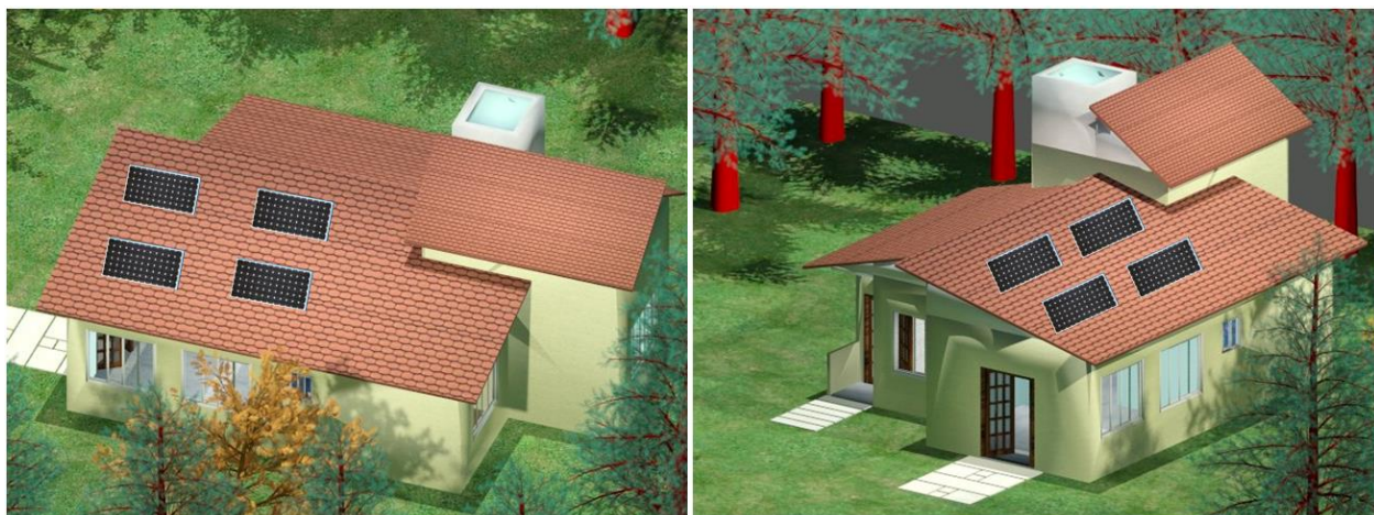
Figura 4- Representação em 3D da residência analisada para implementação do sistema fotovoltaico, onde foi acoplado dos painéis para seu melhor posicionamento.
