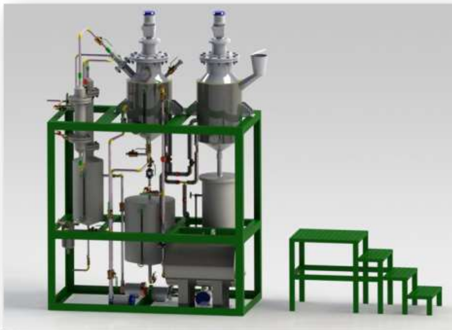
Figura 9 – Unidade de extração de óleo – Vista 3D
